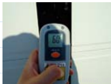
鉄柱は屋外側では 60 度にも達する
